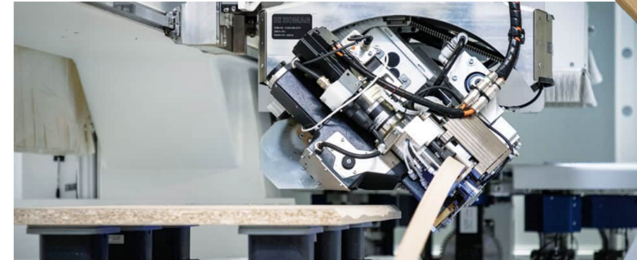
powerEdge Pro Duo macht's möglich: einstufige Waldkante mit freiem Winkel.
