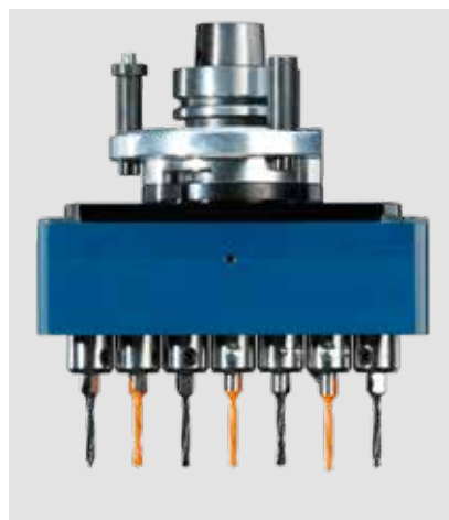
Bohren 7 Spindeln, 25 mm Raster
