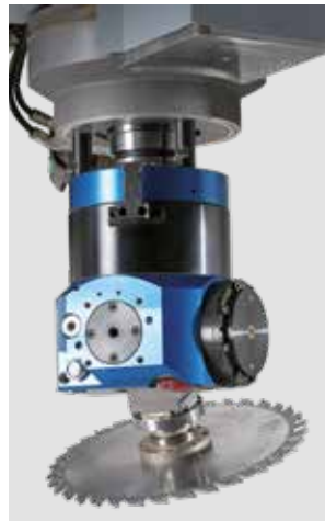
Erweiterung auf FLEX5 bestehend aus FLEX5-Schnittstelle und FLEX5-Aggregat
